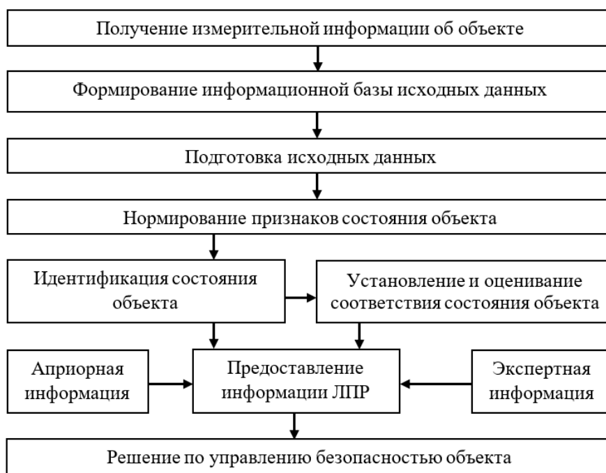
Рис. 1. Блок-схема алгоритма идентификации состояния объекта Пример кластерного разделения состояний торфяника на основе тестовых данных, реализованный в MATLAB, показан на рис. 2.
