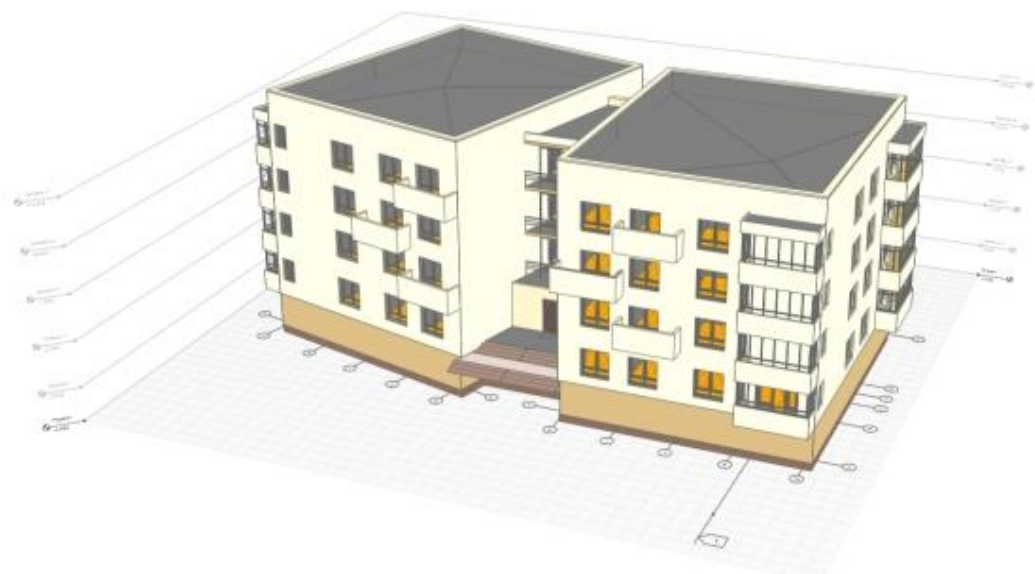
Рисунок 1 – Информационная модель здания из CLT панелей
